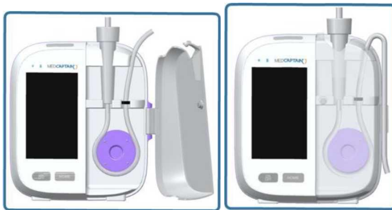
Рисунок 12. Установка набора для энтерального питания на насос
