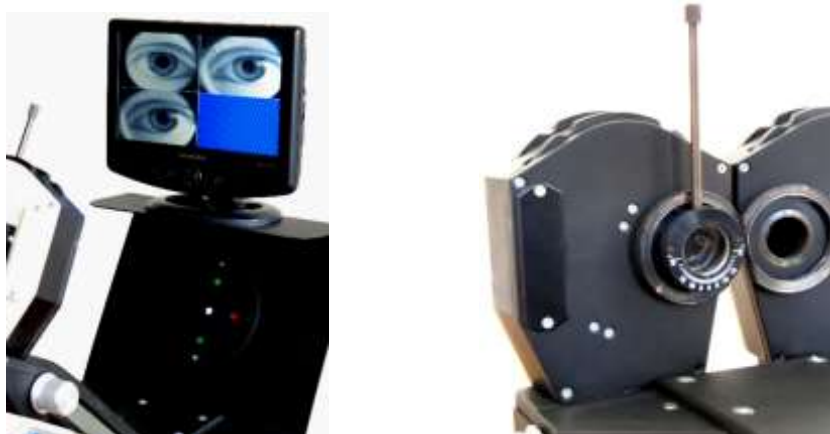
Рисунок 16 Призматический компенсатор, установленный в аппарате
