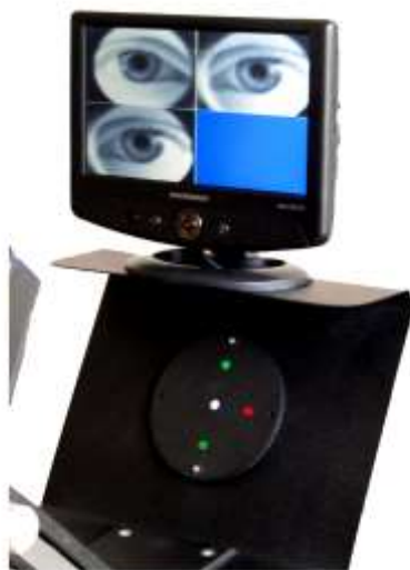
Рисунок 7 – Основное положение аппарата с четырехточечным цветотестом
