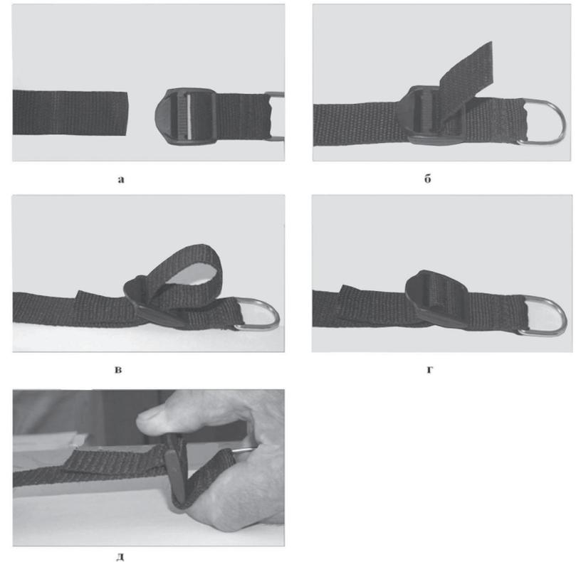
Рисунок А12 – Соединение ремней с помощью трехщелевой пряжки
