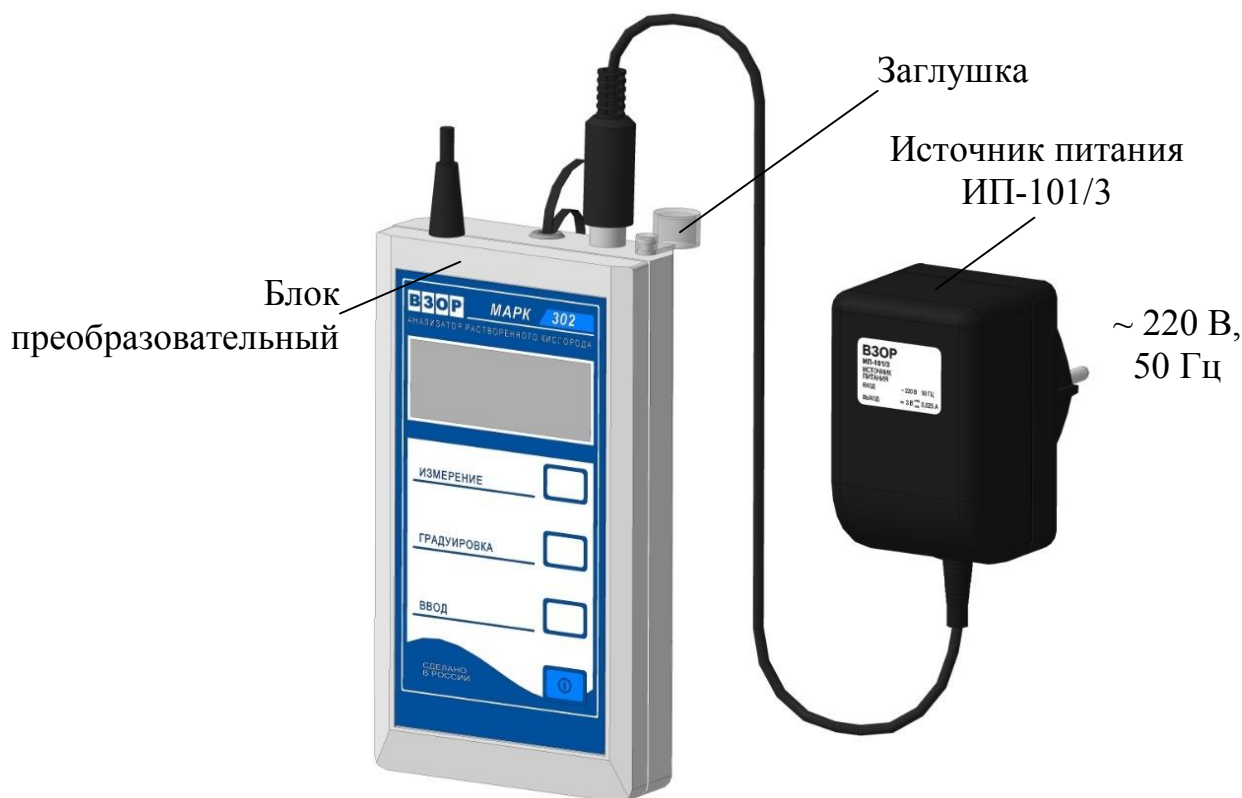
Рисунок 3.2 – Зарядка аккумуляторных батарей
