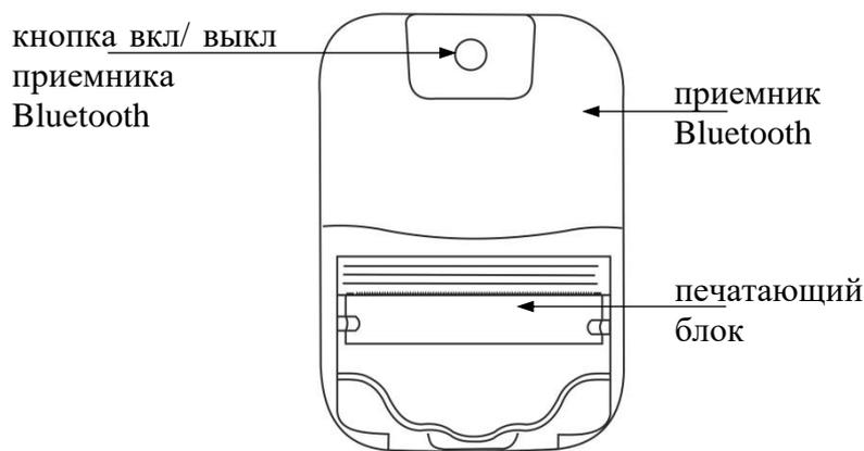
Рисунок 3 – Внешний термопринтер
