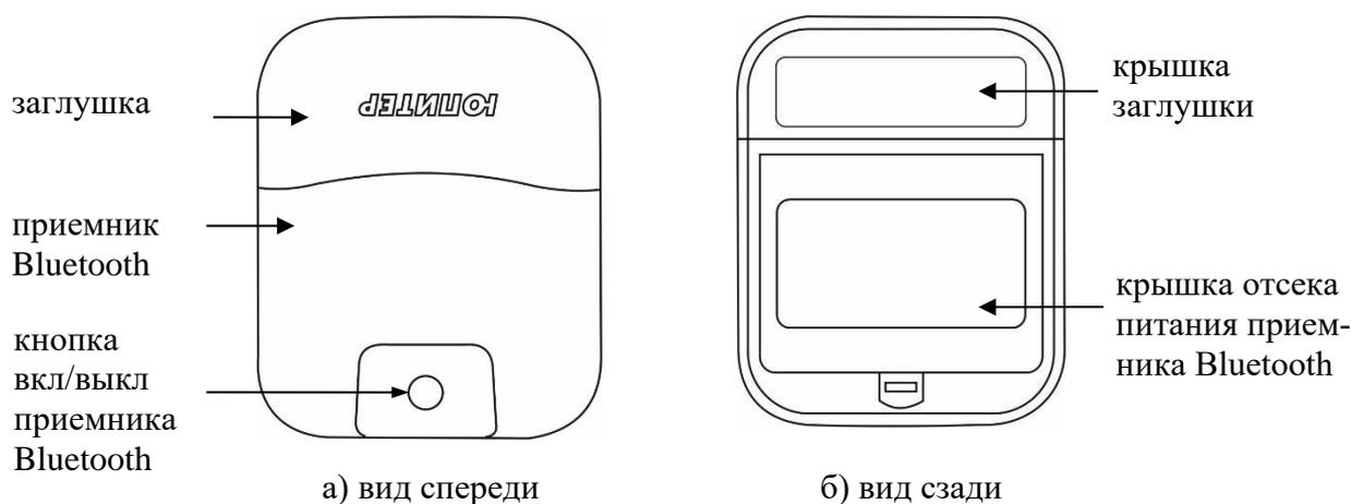
Рисунок 28 – Приемник Bluetooth и заглушка в соединенном виде
