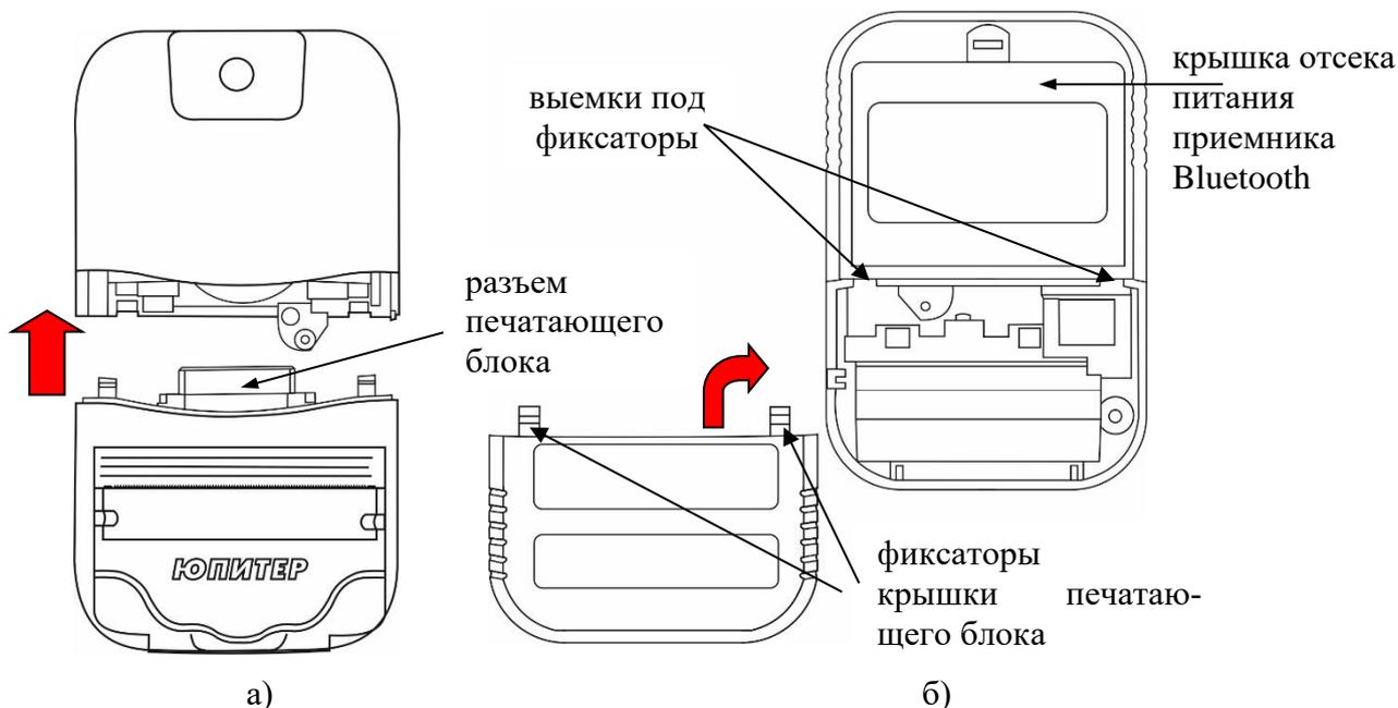
Рисунок 33 – Соединение печатающего блока с приемником Bluetooth
