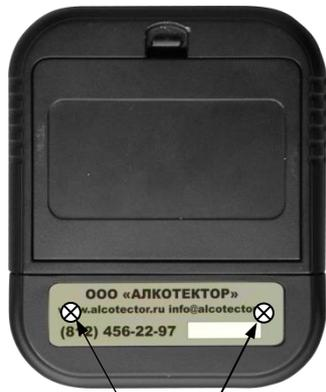
места установки крепежных винтов под наклейкой
