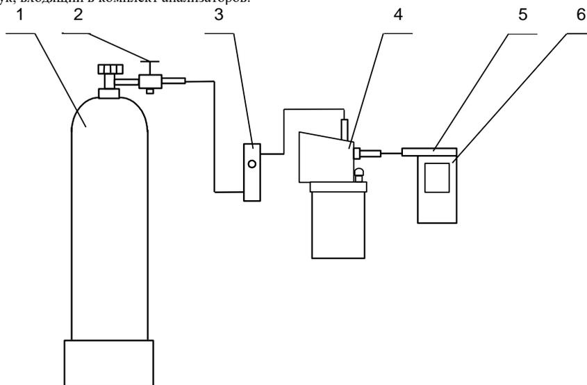
1 – баллон с воздухом; 2 – вентиль; 3 – ротаметр; 4 – генератор;
