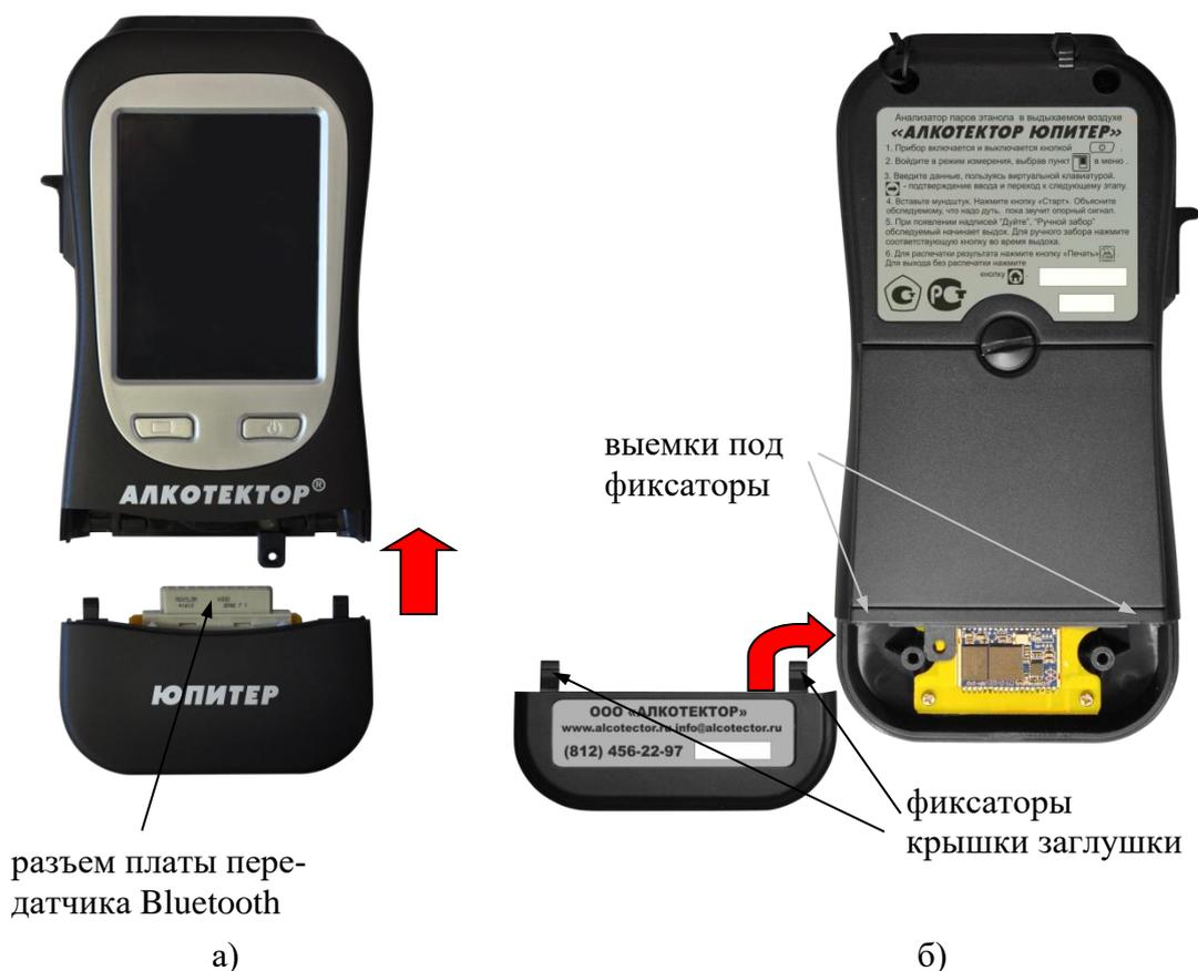
Рисунок 32 – Подсоединение заглушки к основному блоку анализатора
