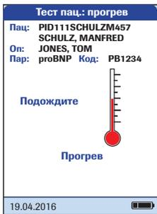
Символ термометра обозначает, что идет прогревание тест-полоски. По окончании прогрева раздастся звуковой сигнал (если включен зуммер).
