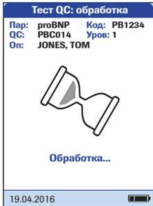
Когда начнется обработка пробы, на экране появится значок песочных часов. Для оптимального контроля над процессом измерения следует всегда самостоятельно подтверждать нанесение, а не ждать, пока прибор обнаружит пробу.
