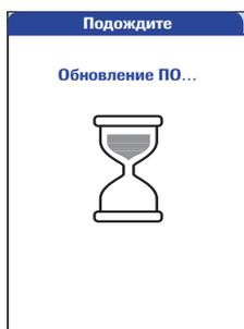
Обновления программного обеспечения устанавливаются через DMS. Анализатор принимает обновления, запущенные в DMS, только в режиме ожидания и при отображении не менее трех сегментов в символе батареи. В процессе обновления отображается расположенный слева экран.
