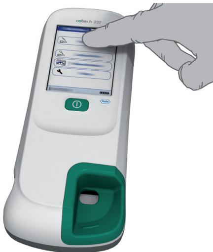
Отображаемые на экране функции активируются нажатием кнопки пальцем или специальным стилусом. «Нажать» кнопку — означает коснуться сенсорного экрана, затем отнять палец от него. После этого открывается следующий экран.
