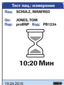
Вращающийся значок песочных часов отображается, пока не будет обнаружена проба и не начнется процесс исследования. На экране отображается время, оставшееся до окончания исследования.
