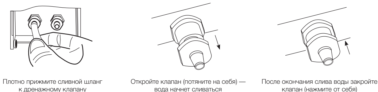
Рис. 5. Порядок слива использованной воды из бака стерилизатора
