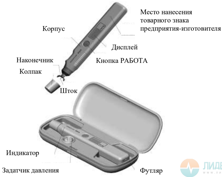
Рисунок 1 – Внешний вид индикатора ИГД-03
