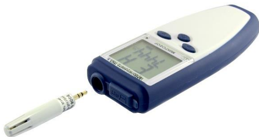
Рис.3. Извлечение зонда из блока индикации термогигрометра ИВА-6Н при поверке.
