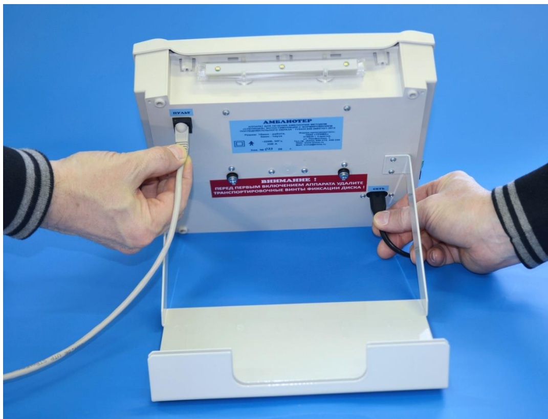
Рис. 3. Расположение разъёмов на задней стенке корпуса электронного блока аппарата "АМБЛИОТЕР".
