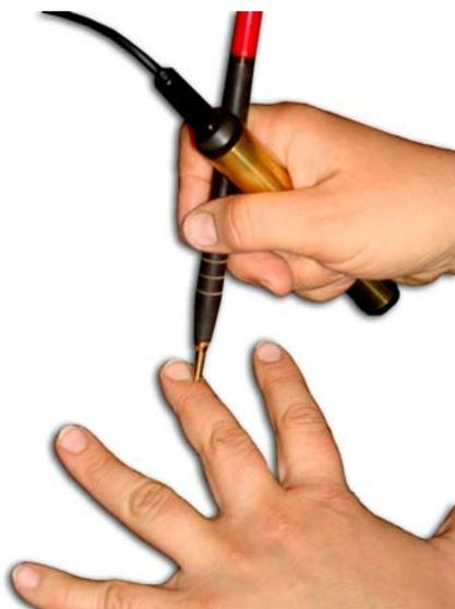
**Самообследование** проводят следующим образом. В одну руку одновременно берут и цилиндрический электрод, и электрод-щуп. Другую руку размещают на столе и по ней проводят измерения. Допускается размещение цилиндра в измеряемой руке.
