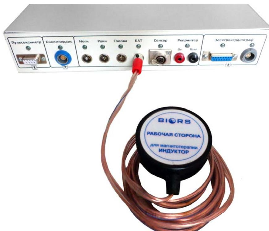
**Форма импульса:** прямоугольная, треугольная, синус, экспонента, спайк. Моно-двухфазный. Скважность: 8. Постоянная частота либо плавное изменение частоты. Возможность задания программы терапии из списка последовательных частот.
