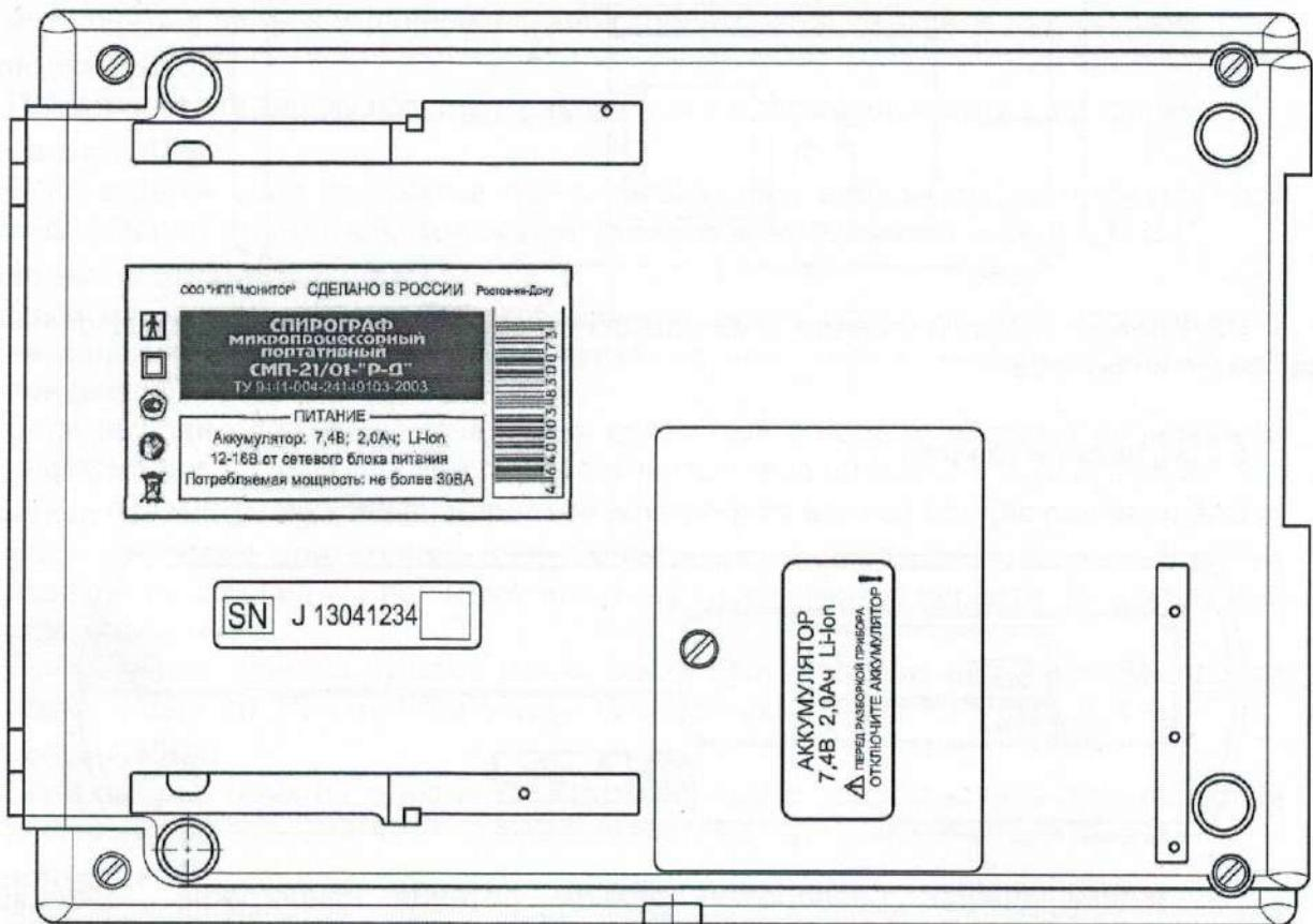
На нижней панели расположен аккумуляторный отсек спирографа.
