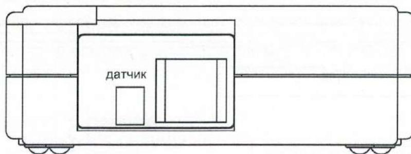
На правой боковой панели расположен разъем **ДАТЧИК** для подключения датчика спирографа.
