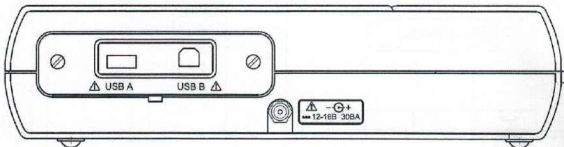
На задней панели расположен разъем питания спирографа, имеющий обозначение: **=12-16В 30ВА** с меткой  $\Delta$ . К этому разъему должен подключаться только источник питания из комплекта поставки спирографа или питание от аккумулятора автомобиля скорой помощи.
