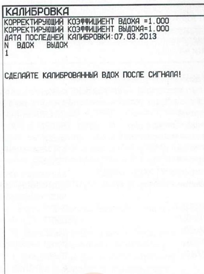
После звукового сигнала произведите калибровочный вдох, плавно выдыхая ручку шприца до упора. Калибровочный вдох следует производить плавно, без рывков за время не более 1 секунды. Результат измерения калибровочного вдоха появится на экране, а сообщение "ПРОИЗВЕДИТЕ КАЛИБРОВАННЫЙ ВДОХ ПОСЛЕ СИГНАЛА!" сменится на "ПРОИЗВЕДИТЕ КАЛИБРОВАННЫЙ ВЫДОХ ПОСЛЕ СИГНАЛА!".
