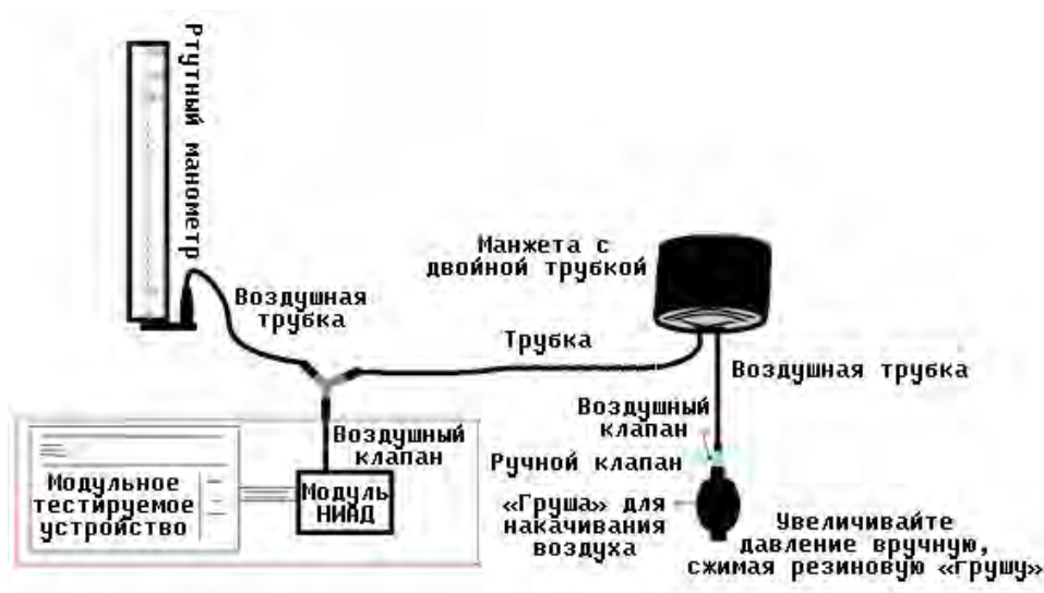
Рисунок 3.5 Подсоединение калибровочного устройства
