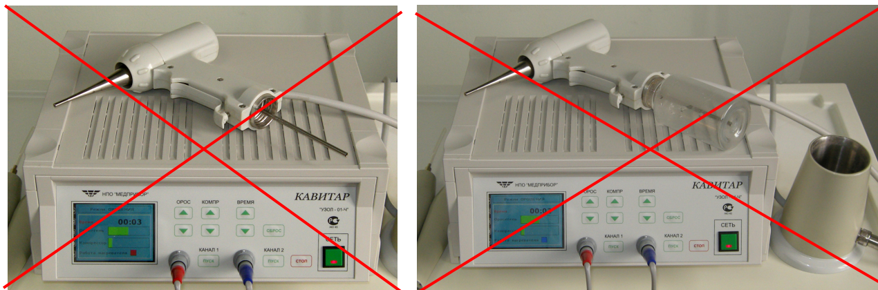
Рисунок 3 – Запрещенные положения рукоятки оросителя для любой поверхности
