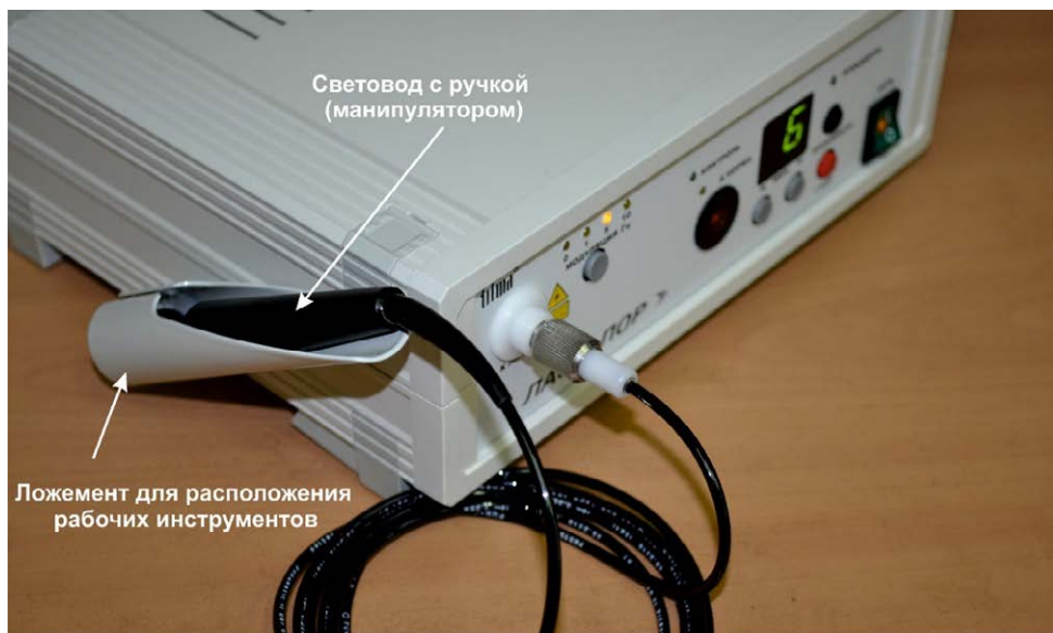
Рис.2. Ложемент для установки рабочих инструментов (световода с манипулятором или магистрального световода К-лазера).
