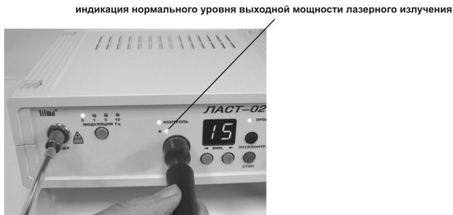
Рис. 10. Проверка соответствия уровня выходной мощности излучения.
