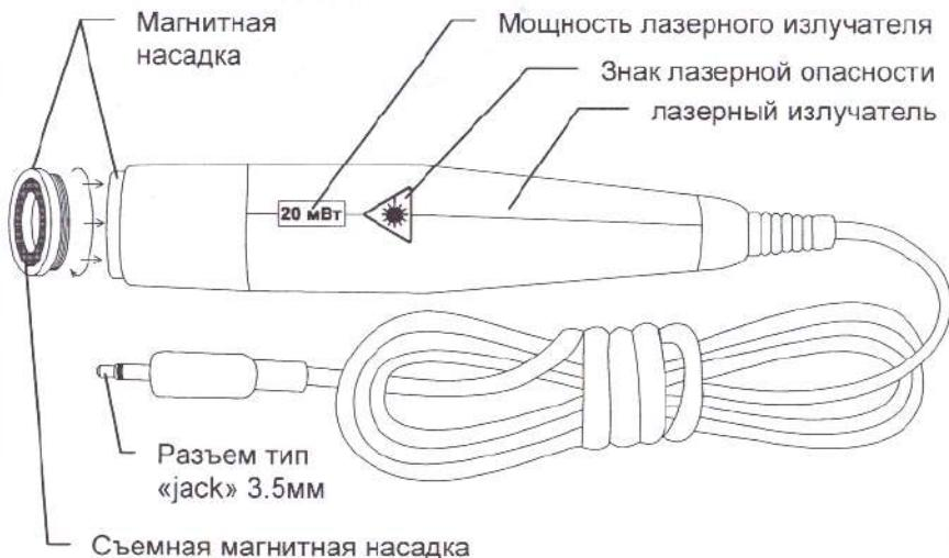
**ВНИМАНИЕ!** Магнитная насадка по умолчанию установлена на лазерный излучатель. Для установки конической или оптических насадок не входящих в стандартную комплектацию необходимо выкрутить (против часовой стрелки) магнитную насадку.
