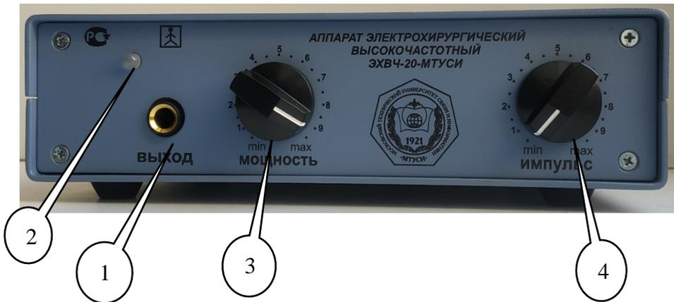
1. Выход для подключения электрододержателя спрей-коагуляции
