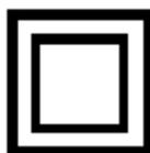
Определение: оборудование класса II – оборудование, в котором защита от удара электрическим током основана не только на БАЗОВОЙ ИЗОЛЯЦИИ, но предусмотрены и имеются дополнительные меры предосторожности, такие как ДВОЙНАЯ ИЗОЛЯЦИЯ или АРМИРОВАННАЯ ИЗОЛЯЦИЯ, не учитываются защитное заземление или использование условий установки
