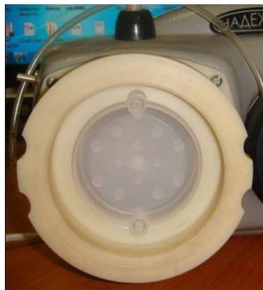
«Держатель с кюветой УФОК» вставляется в байонетное крепление на корпусе аппарата УФО крови «Надежда-О» и гарантированно удерживается 1 лепестком вставленным в верхний паз корпуса. Для установки «держателя УФОК с кюветой» на корпусе аппарата необходимо снять силиконовое кольцо на внутреннем подвижном капроновом кольце камеры облучателя.
