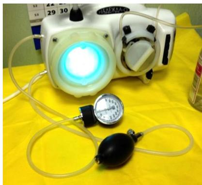
4.3. Облучение производится высокочастотной лампой ИВР (индукционная всеволновая ртутная), обеспечивающей 92% мощности облучения в области УФ-С 180-280 нм при энергетической освещенности на поверхности кюветы 3 мВт/кв.см.
