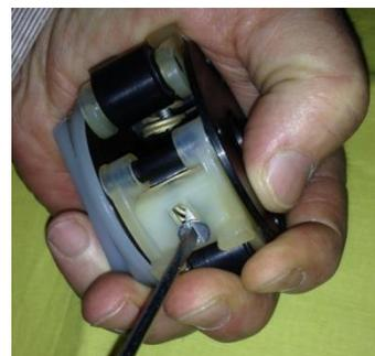
ⓂⓂ Принцип работы любого роликового перистальтического насоса основан на пережатии трубки и, вследствие этого, происходит протягивание трубки с последующим образованием на ней гофров.
