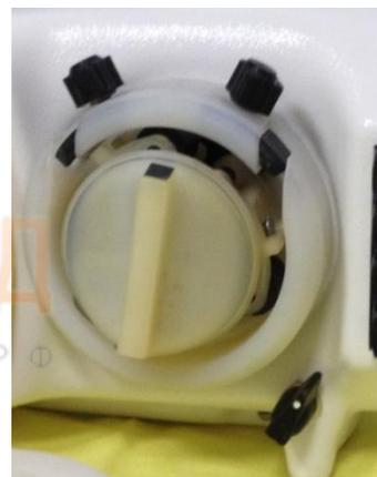
Ротор насоса имеет байонетное крепление на валу двигателя в обойме насоса, что позволяет его легко снять рукой, кулисы роликов подпружинены и возможна регулировка на трубку диаметром от 3 до 5 мм. ( фото). Регулировка на различный размер трубки осуществляется изменением размеров выступания роликов путем ослабления или поджатия 3 винтов на роторе при обеспечении за счет шлицев на 3 винтах их надежной фиксации в подпружиненных кулисах ротора.
