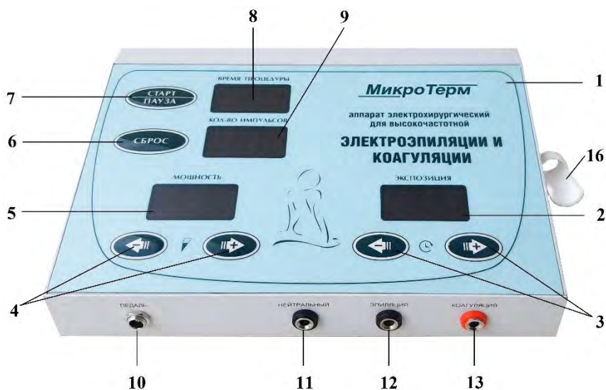
Рисунок 1 – Электронный блок для электроэпиляции и коагуляции 1. Корпус аппарата; 2. Индикатор времени экспозиции; 3. Кнопки регулировки времени экспозиции; 4. Кнопки регулировки мощности; 5. Индикатор мощности; 6. Кнопка «сброс»; 7. Кнопка «старт-пауза»; 8. Индикатор времени процедуры; 9. Индикатор количества импульсов; 10. Гнездо для педали; 11. Гнездо для нейтрального электрода; 12. Гнездо для ручки эпиляции; 13. Гнездо для ручки коагуляции; 16. Держатель для ручки.
