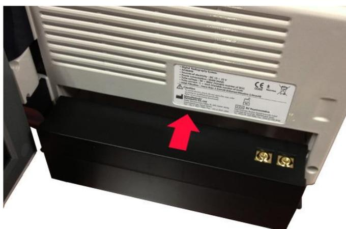
Рисунок 7.16 Установка батареи в основной корпус
