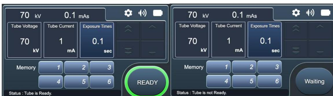
**Рисунок 7.9 Отображение символа статуса трубки, генерирующей рентгеновское излучение**
