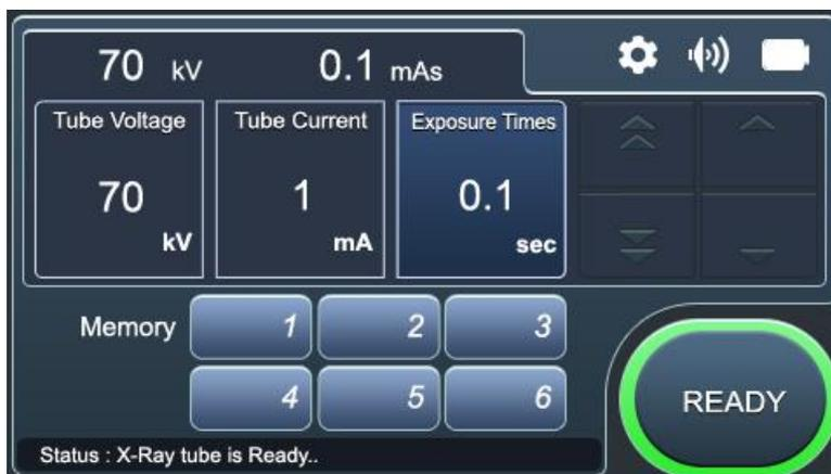
Рисунок 7.10 Готовность к производству рентгеновского снимка
