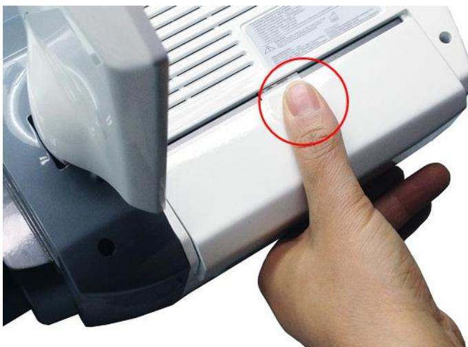
Рисунок 7.15 Снятие крышки основного батарейного отсека
