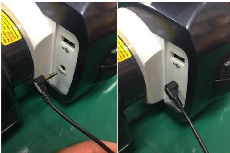
Рисунок 7.14 Проводное подключение дистанционного управления
