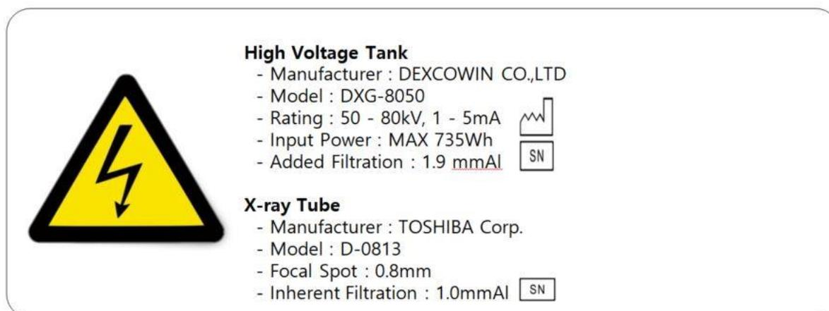
Рисунок 11.6 Ярлык на резервуаре высокого напряжения
