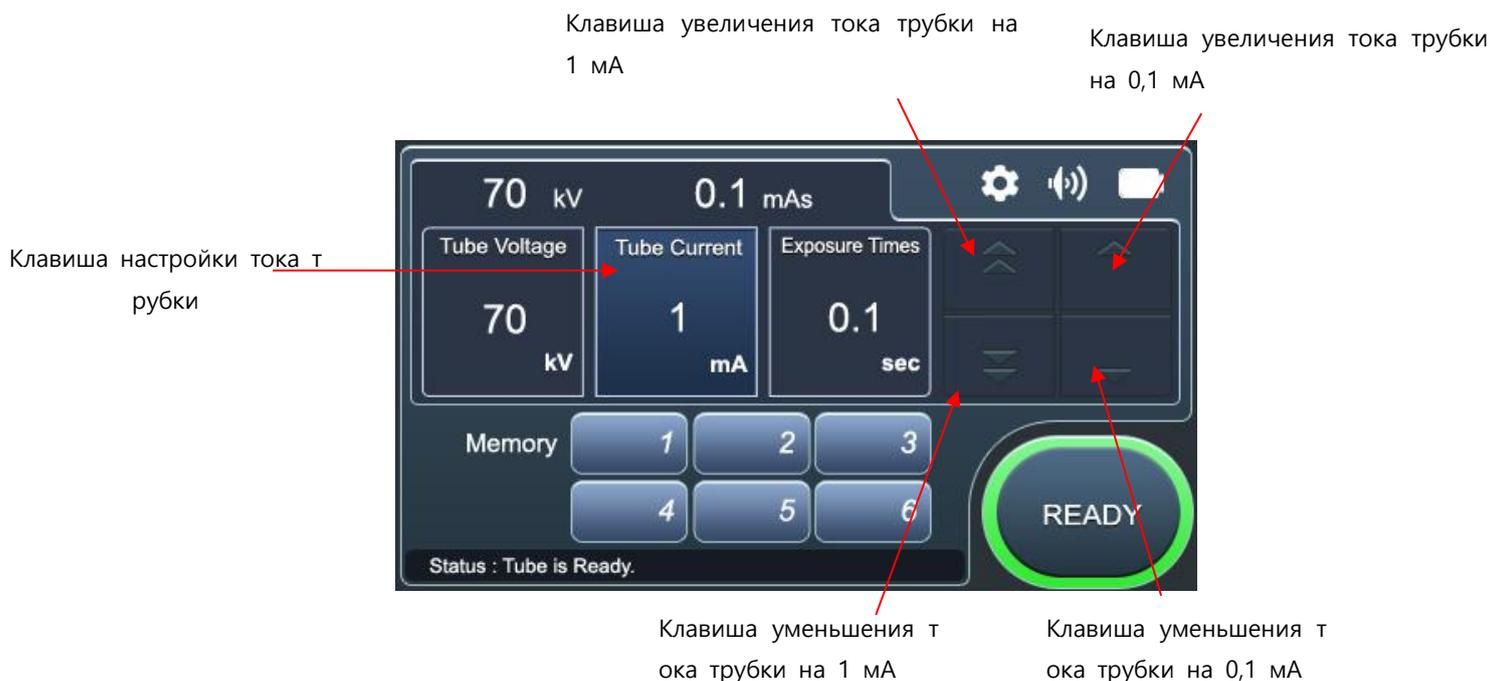
**Рисунок 7.4 Клавиши регулировки тока трубки**
